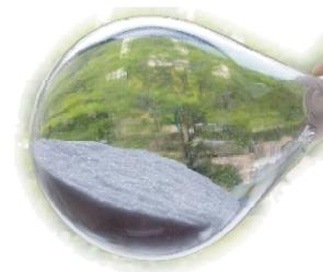
图 6 钙钛矿前驱体-烷基铵盐 (多重结晶, 无水处理, 隔绝密封)
