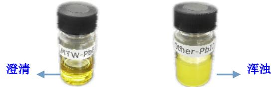
图 8 碘化铅在 DMF 中的溶解情况对比 (60 度)
