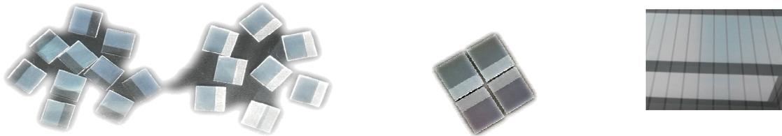
图 12 不同尺寸的刻蚀导电玻璃 (激光刻蚀和化学刻蚀)
