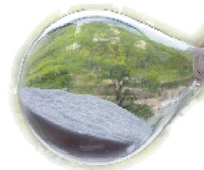
图 9 钙钛矿前驱体-烷基铵盐（多重结晶，无水处理，隔绝密封）
