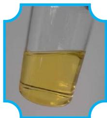
图 12 PbI<sub>2</sub>/DMF 溶液
